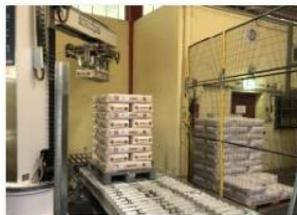
**Bildunterschrift:** Das neue Verfahren mit Palettier-Roboter sorgt dafür, dass die Mehlsäcke nicht mehr so stark zusammengepresst werden.
